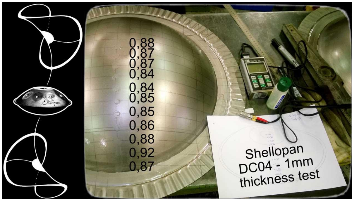
(Dickenverteilung einer Shellopan-Schale aus Charge 1, gemessen mit einer Ultraschallsonde)
