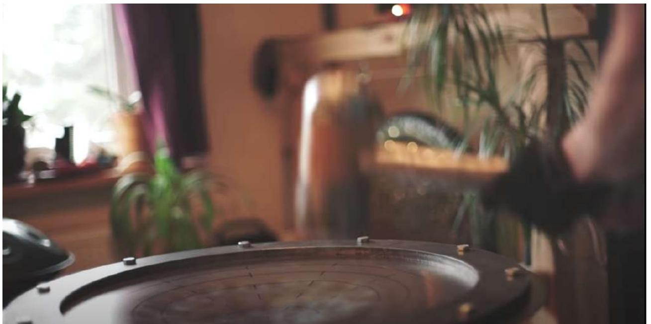
Figura. 2.15 Zbyszek Weglinski demonstra como se afunda uma concha com um martelo de madeira.
